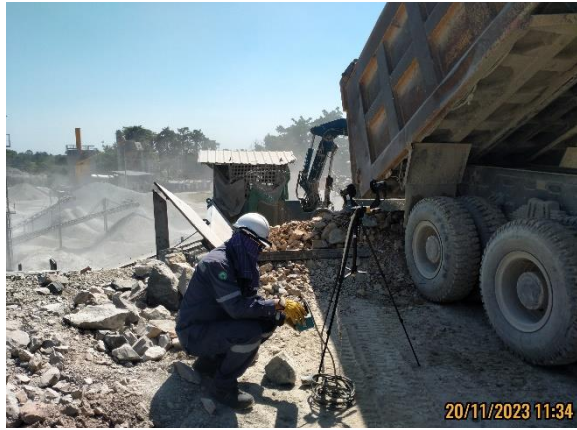
รูปที่ 4.3-7 แสดงการตรวจวัดค่าความทึบของฝุ่นละออง (Opacity) บริเวณบนปากโม (Primary Crusher) วันที่ 20 พฤศจิกายน 2566
