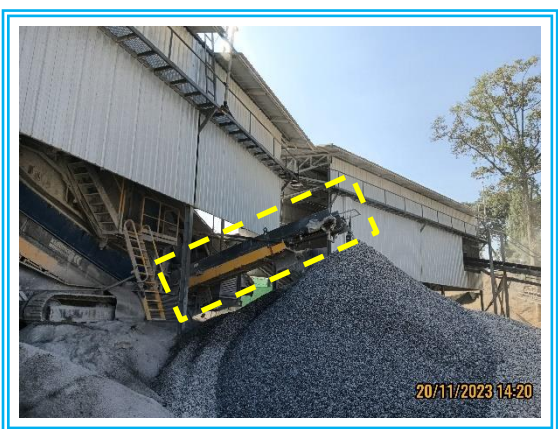
รูปที่ 3-8 สายพานลำเลียงแบบปิดคลุม
