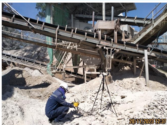
รูปที่ 4.3-9 แสดงการตรวจวัดค่าความทึบของฝุ่นละออง (Opacity) บริเวณจุดถ่ายโอน (Transfer Point) วันที่ 20 พฤศจิกายน 2566
