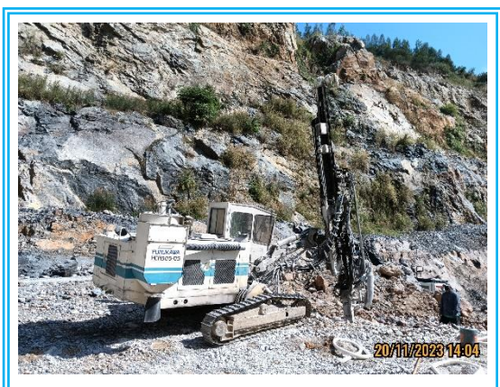
รูปที่ 3-3 เครื่องเจาะระเบิดที่มีอุปกรณ์เก็บฝุ่นติดตั้งไว้กับหัวเจาะ
