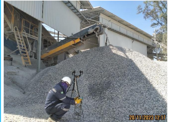
รูปที่ 4.3-8 แสดงการตรวจวัดค่าความทึบของฝุ่นละออง (Opacity) บริเวณตะแกรงคัดขนาดหิน วันที่ 20 พฤศจิกายน 2566
