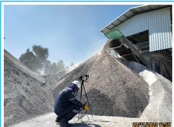
รูปที่ 4.3-10 แสดงการตรวจวัดค่าความทึบของฝุ่นละออง (Opacity) บริเวณปลายสายพานลำเลียง วันที่ 20 พฤศจิกายน 2566
